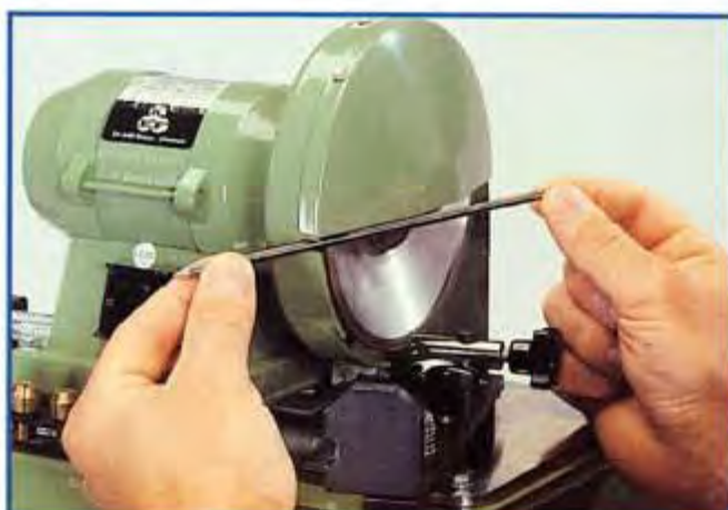
Fig. 5: I venstre side af skærmen er der lavet en lille slids (åbning), som gør det nemt og hurtigt at afkorte elektroden. Se fig. 5.
