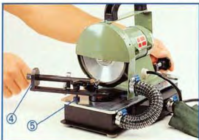
Fig. 2: Den ønskede vinkel indstilles nemt og hurtigt ved at løse støttebenet ⑤ og flyt armen ④ til den ønskede vinkel. Når den ønskede vinkel er fundet fastspændes støttebenet ④ igen.
