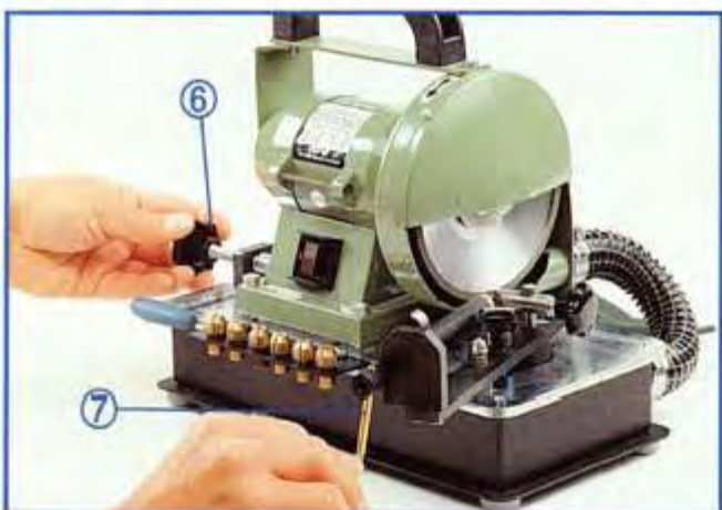
Fig. 3: Ved at dreje håndtag ⑥ med venstre hånd skubbes diamantskiven mod elektrodespidsen medlens elektrodespidsen drejes rundt med højre hånd ved hjælp af håndsvinget ⑦. Efter få sekunders slibning er den ønskede vinkel opnået og elektroden klar til svejsning.
