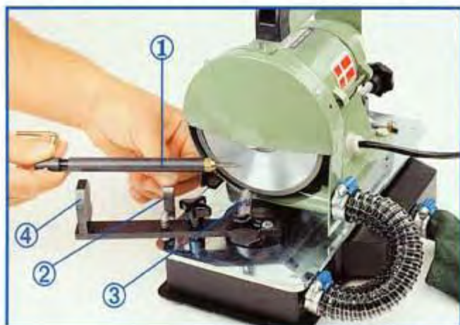
Fig. 1: Elektrodeholderen ① indsættes nemt ved at trykke tilbage på fjederen ②. Spidsen af elektroden indsættes i elektrodestyret ③ og elektrodeholderen indsættes i halvmånen for enden af armen ④. Fjederne slippes og holder herefter elektrodeholderen og elektroden sikkert på plads.
