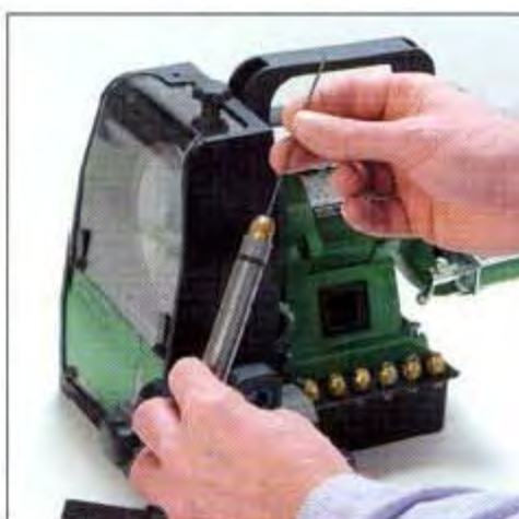
Isætning af elektrode i messingholder. Fastspændes let så den kan skubbes til mål af korrekt slibevinkel.
