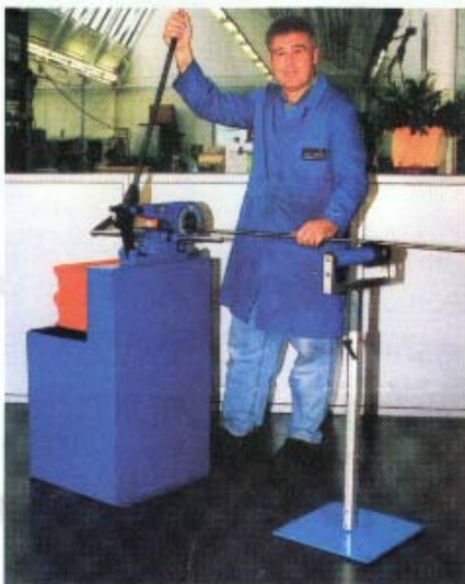
Typ BS 2 mit Maschinenfuß und 1 Materialauflagegeständer
